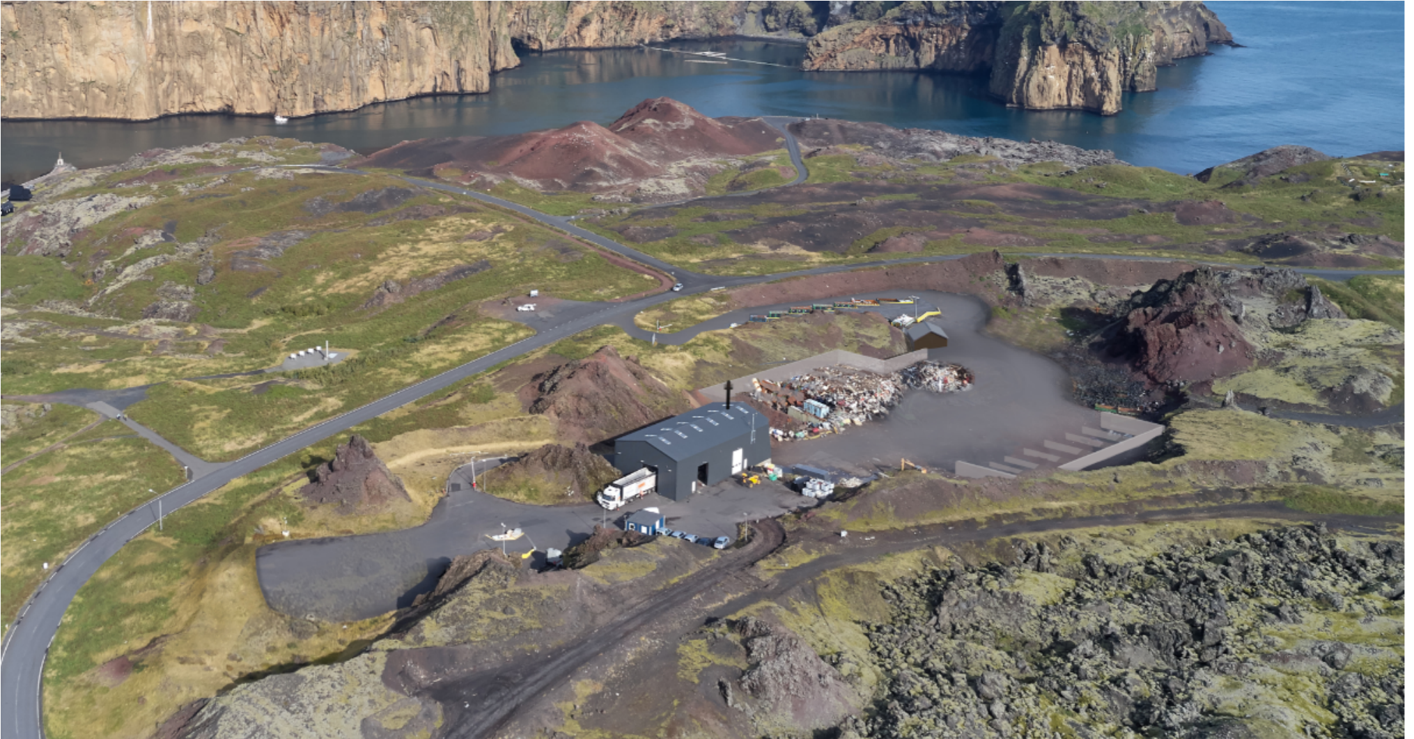
Mynd 3.10. Gróf tölvuunnin mynd af móttöku- og flokkunarstöðinni við Eldfellsveg sem gefur vísbendingu um hvaða breytingar verða á ásýnd. Búið er að færa aðkomu að svæðinu norðar ásamt flokkunaraðstöðunni fyrir almenning. Aðstaða á vinnusvæðinu bætt með frágengnu yfirboði, steiptum efnishólfum, byggingu sem er aðstaða fyrir starfseminu við flokkunarsvæðið og tekið til á svæðinu næst hraunmyndunum til hægri á myndinni.
